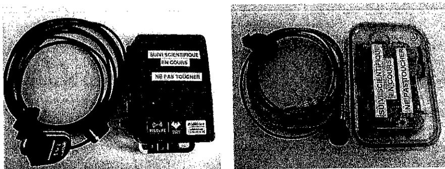
*Figure 4 : à gauche : Song Meter 4 (Wildlife acoustics) ; à droite : Passive Recorder (Teensy Recorder)*
